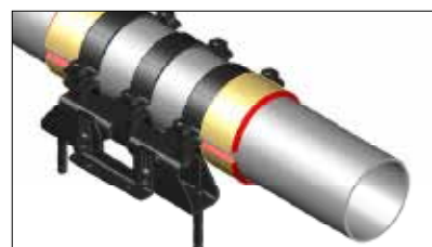
verschweisster Anschlag an allen Fixpunkten F > 14.0 \text{ kN}
